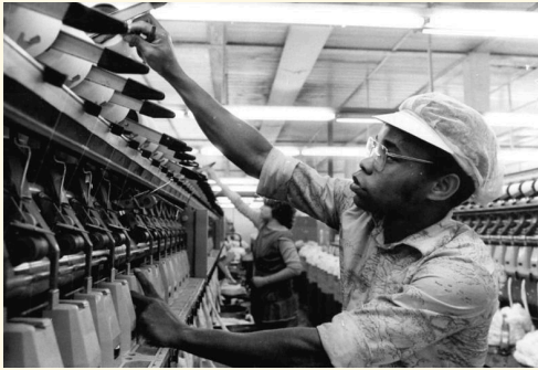
João Nanelo aus Mosambik repariert eine Spinndüse im Maschinensaal der Baumwollspinnerei Mittweida.
